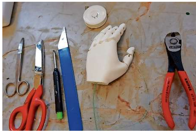
Eine der ersten Handprothesen aus dem Drucker: In der Werkstatt werden die einzelnen Teile zusammengebaut.
