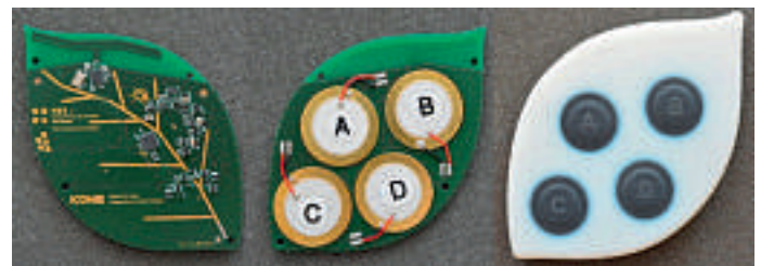
Bild 1: HSRvote battery free: PCB Unterseite (links), Oberseite mit Piezotasten (Mitte), Gehäuseprototyp (rechts)
