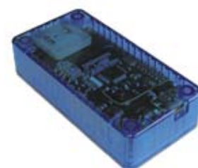
Abb. 1: GPS-Tracker (Abmessungen 10 x 5 x 2.5 cm)
