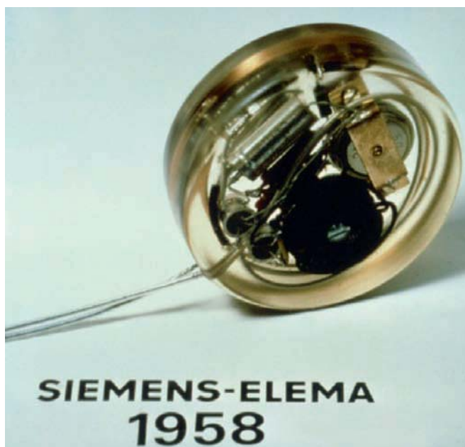
Erster implantierter Herzschrittmacher (1958). Er wurde in einer Schuhcremedose eingebaut und mit Epoxidharz vergossen. Die beiden Transistoren sind deutlich zu erkennen.
