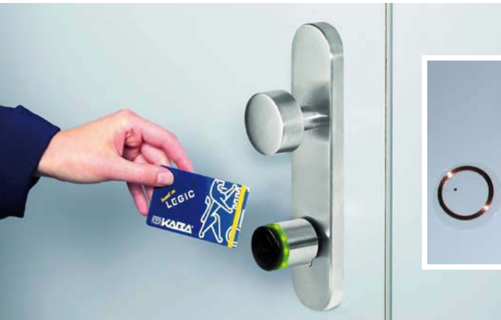
RFID-System in der Zugangskontrolle und Beispiele von RFID-Transpondern.
