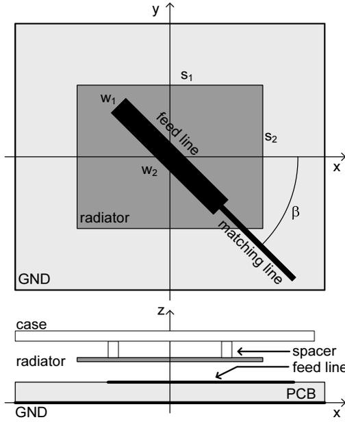
Fig. 1. Antenna design parameter of 5.8 GHz LHCP patch antenna.
